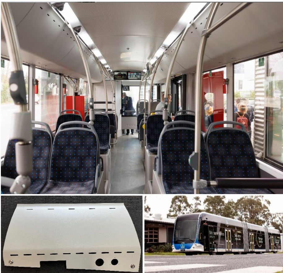
Oben: Innenansicht des Elektrobusses; unten links: thermogeformter Dachrahmendeckel aus SIMORAIL HL3; unten rechts: Außenansicht des Elektrobusses
