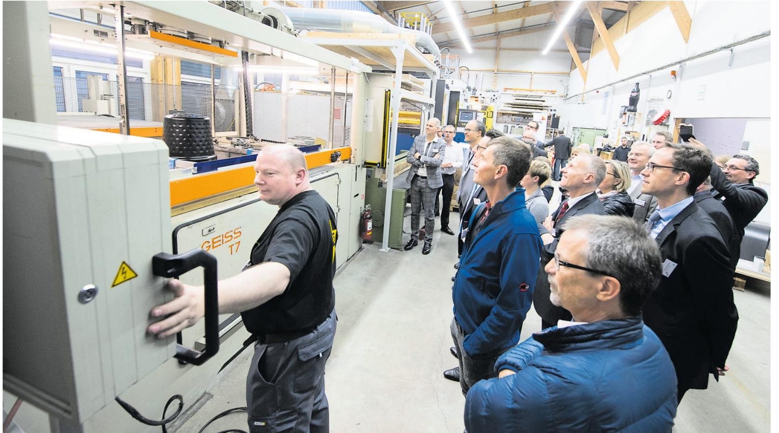
Grosses Interesse der «Gesichtspunkte»-Besucher an der Maschine fürs Thermoformen: Hier entsteht ein Kunststoffteil nach Mass für ein Flugzeug, einen Bus oder den Tiefbau – doch auch ein überdimensionaler Fingerhut (im Bild in der Maschine), der an der Expo O2 als Sitzgelegenheit diente, ist ohne Probleme machbar. Bilder: Eveline Beerkircher
