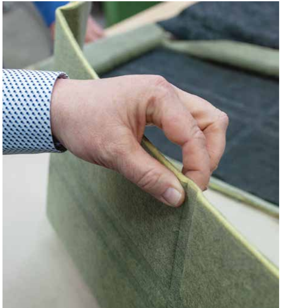
Bodenschutzbelag für Helikopter: Das fluffige Vlies erzielt durch den Verarbeitungsprozess hohe Festigkeiten an den Rippen. In den Zwischenräumen ist es dicker und etwas weicher, der Dämmeffekt dafür höher.
