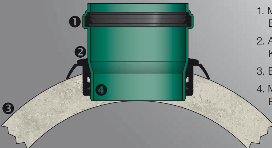
1. M.O.L. Dichtung DN 150 / DN 200 Euro L Spezial
