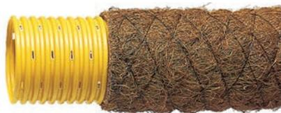
Alternativ wird EURODRAIN auch mit einem thermisch verfestigten Polypropylen-Vlies ummantelt. Das sich überlappende Filtermaterial wird mit Fäden fest auf dem Rohr befestigt. Der Filter eignet sich für leichte, sandige und lehmige Böden mit stabilem Gefüge.
